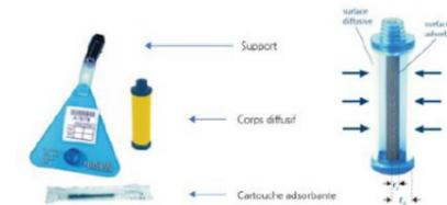
Figure 22 : Echantillonneur passif Radiello
